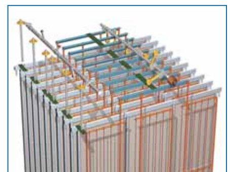
Elektrisches Sprühsystem (Gasreinigungszone)
